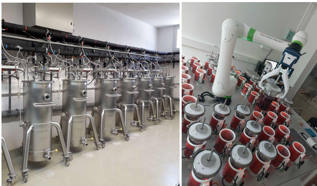
Salle de fermenteurs (gauche) et robot de microvinification (droite)
