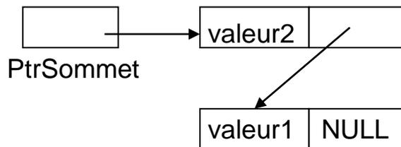
Un élément d'une pile est composée d'une valeur et d'un pointeur sur l'élément précédent.
